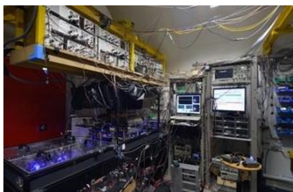
Dispositif expérimental au SYRTE d'une horloge optique à atomes de Sr. ©SYRTE
